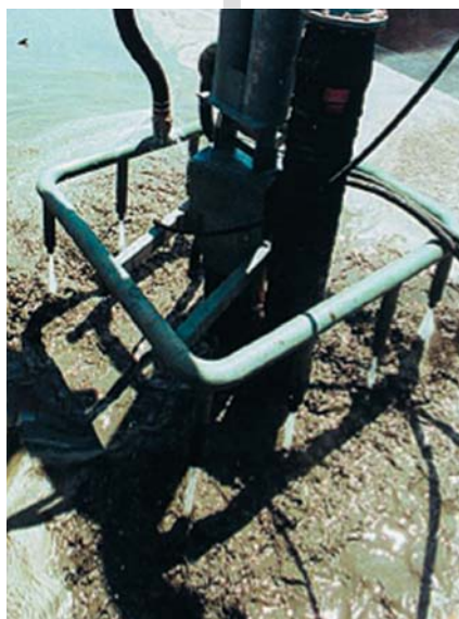
ET DHY 85 - Разгрузка баржи с песком
