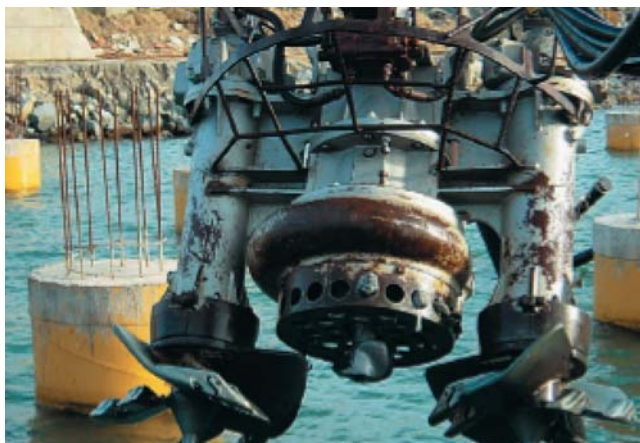
ET DHY 85B + ET DEXHY 20 – Погружение на дно для добычи песка
