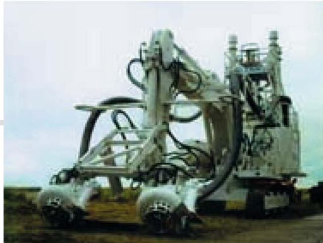
«Сдвоенная» комплектация насосов и экскаваторов для удвоения производительности.
