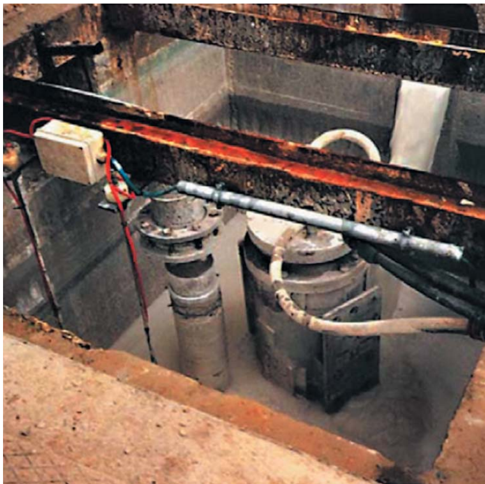
ET DEL 60B - Откачка мраморной пыли из сборного бака в производстве при резке мрамора
